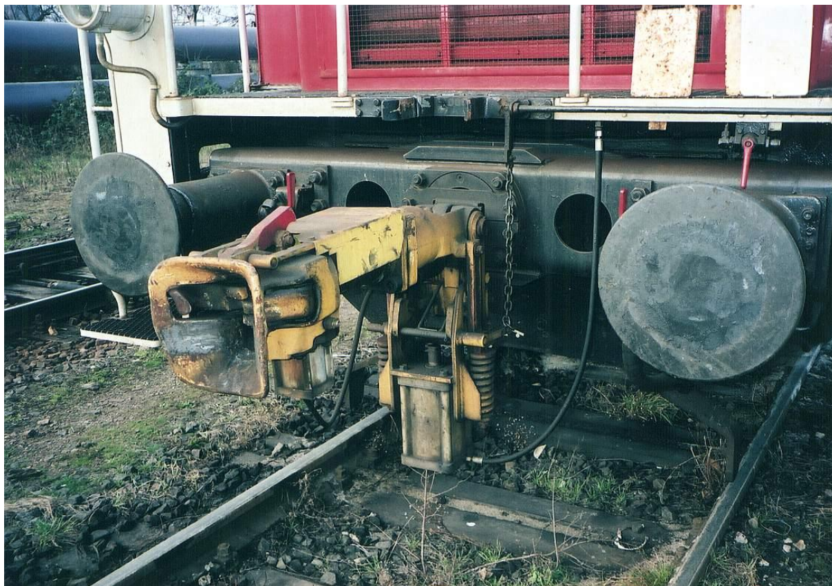
Obrázek 13 - Detail "pneumaticky ovládaného" spřáhla na lokomotivě
