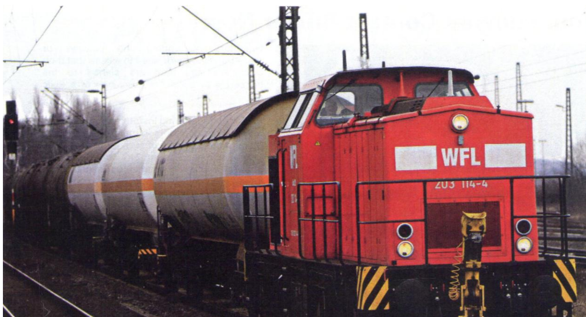
Obrázek 12 - Lokomotiva vybavena "pneumaticky ovládaným" spřáhlem
